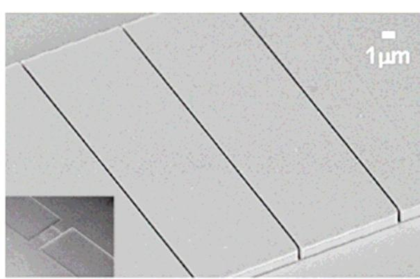
Рис. 9.3. Отпечаток Ni штампа в 8 мкм слое резистивного материала PMMA. Вставка слева: вид отпечатка с меньшим увеличением [27]
