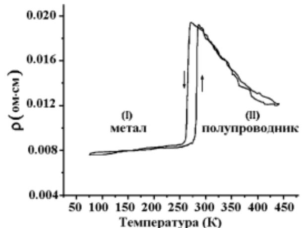
Рис. 1. Зависимость удельного сопротивления от температуры для пленок нитрида хрома [8].
