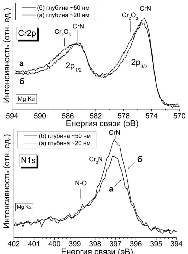
Рис. 3. РФЭС спектры фотоэмиссии оставшегося уровня 2p хрома (сверху) и 1s азота (снизу) на глубине  $\sim 20$  нм (а) и  $\sim 50$  нм (б).
