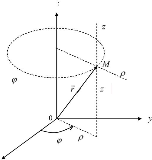
Рис. 2.3 Цилиндрические координаты. Пунктирными линиями показаны координатные линии цилиндрических координат
