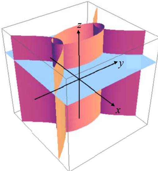
Рис. 2.10. Координатные поверхности цилиндрических эллиптических координат
