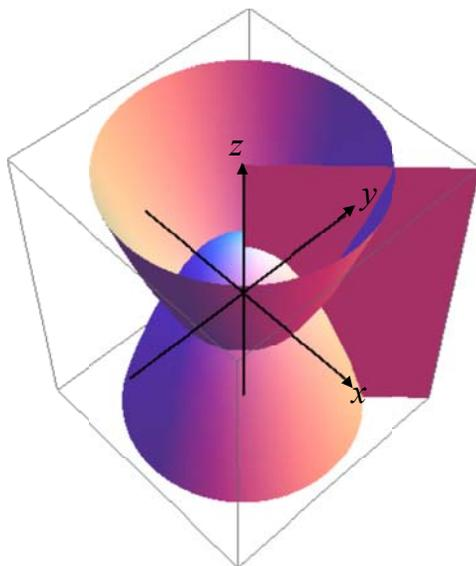
**Рис. 2.12. Координатные поверхности параболических координат вращения**
