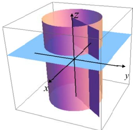
Рис. 2.4. Координатные поверхности цилиндрических координат
