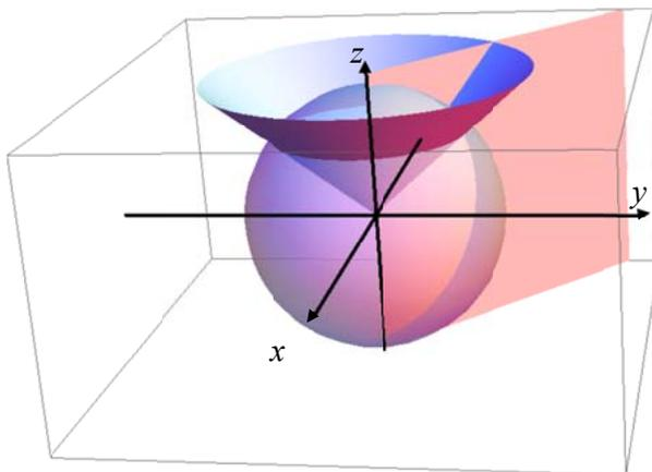
**Рис. 2.6. Координатные поверхности сферических координат**
