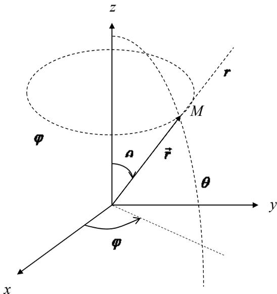
**Рис. 2.5. Сферические координаты. Пунктирными линиями показаны координатные линии сферических координат**
