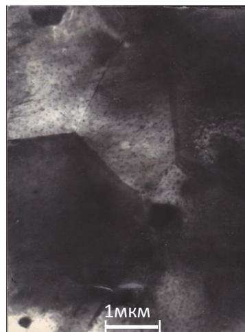
Рис. 3.6. Микроструктура сплава Zr-Nb-Fe при температуре отжига 970 К, 15ч
